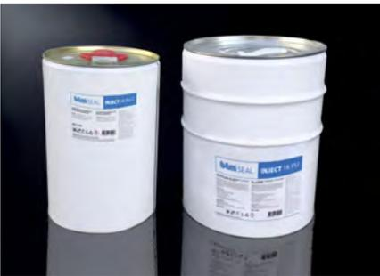
BTMSEAL INJECT 1K PU; tek komponentli, poliüretan esaslı, beton elemanlardaki çatlak ve gözeneklerden sızan suyu engellemek için geliştirilmiş yarı esnek, hidrofobik köpük enjeksiyon malzemesidir. Düşük vizkoziteli olduğu için yapı elemanındaki boşluklara hızlı bir şekilde ve derinlemesine nüfuz ederek su sızıntılarını veya kaçaklarını etkin bir şekilde durdurur.
